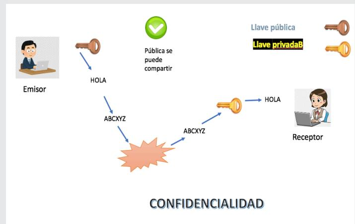
Figura 2. Criptografía Asimétrica.
